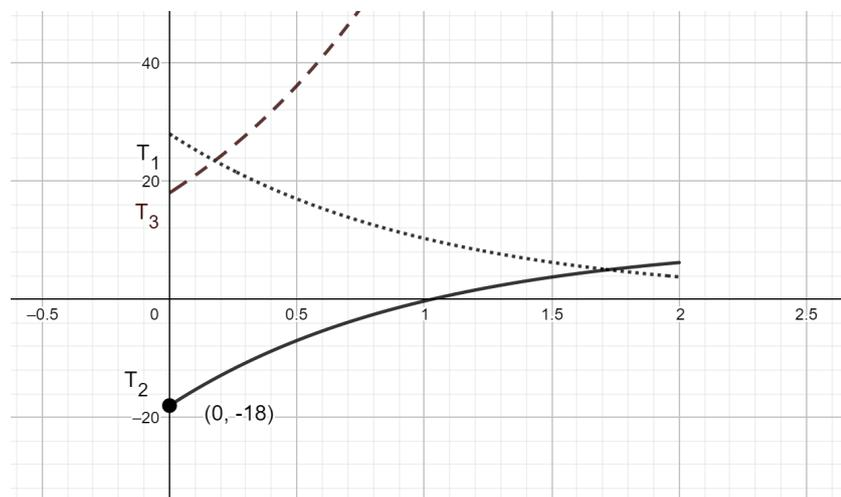
Damit der Block nicht in den 2 Minuten zu schmelzen beginnt, muss die Temperatur in dieser Zeit unter 0 bleiben, d.h. also es muss  $T_2(2) < 0$  sein.
