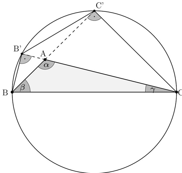
An den Fußpunkten  $C'$  und  $B'$  sind rechte Winkel. Da diese Punkte über der Seite BC sind, liegen sie auf dem Umkreis mit dem Durchmesser BC (Satz von Thales). Alle vier Punkte des Vierecks  $BB'C'C$  liegen somit auf diesem Umkreis, was zu zeigen war.
