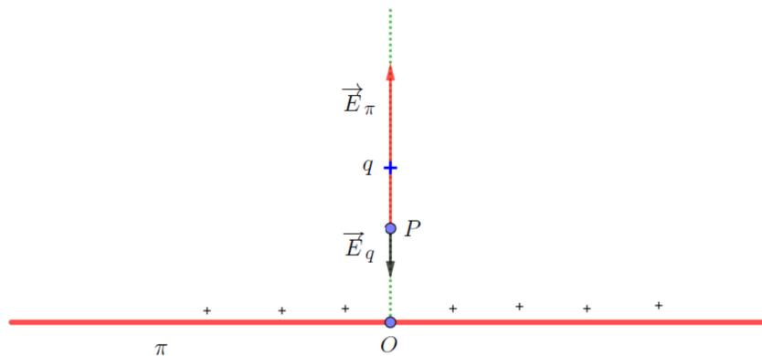
Die beiden Feldstärkevektoren zeigen hier in entgegengesetzte Richtung, da beide Ladungen positiv sind. Die Richtung der resultierenden Feldstärke wird durch die größere Feldstärke festgelegt.
