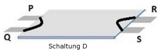
Du baust einen Stromkreis wie in nebenstehender Skizze zusammen. Dann verbindest du die blanken Enden der Kabel mit verschiedenen Anschluss-Paaren der Schaltung. Dadurch findest du heraus, welche Schaltung du vor dir hast.
