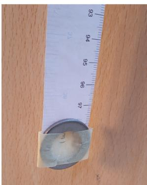
1. Um den Papier-Meterstreifen zu spannen, befestigst du unten mit dem Klebestreifen eine Beilagscheibe (siehe Foto). Diese Beilagscheibe benötigst du später auch für andere Messungen. Hierfür musst du sie durch eine andere ersetzen.
