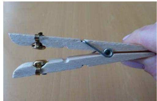
An den Musterbeutelklammern wird jeweils eine Krokodilklemmen angeschlossen. Wird die Holzklammer zusammengedrückt, wird der Stromkreis geschlossen und die Glühlampe brennt.
