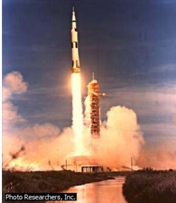
Eine Rakete ist ein länglicher Flugkörper, der wie ein Zylinder aussieht und oben spitz zuläuft wie ein Bleistift. Am unteren Ende der Rakete befinden sich die Düsen. Mit ihnen kann eine Rakete fliegen, ohne dass sie dazu noch ein anderes Hilfsmittel benötigt. Ein Flugzeug kann z. B. nur deswegen aufsteigen, weil es durch die Luft Auftrieb erhält. Eine Rakete hingegen fliegt völlig unabhängig von ihrer Umgebung und kann sich deswegen auch im luftleeren Weltraum bewegen.
